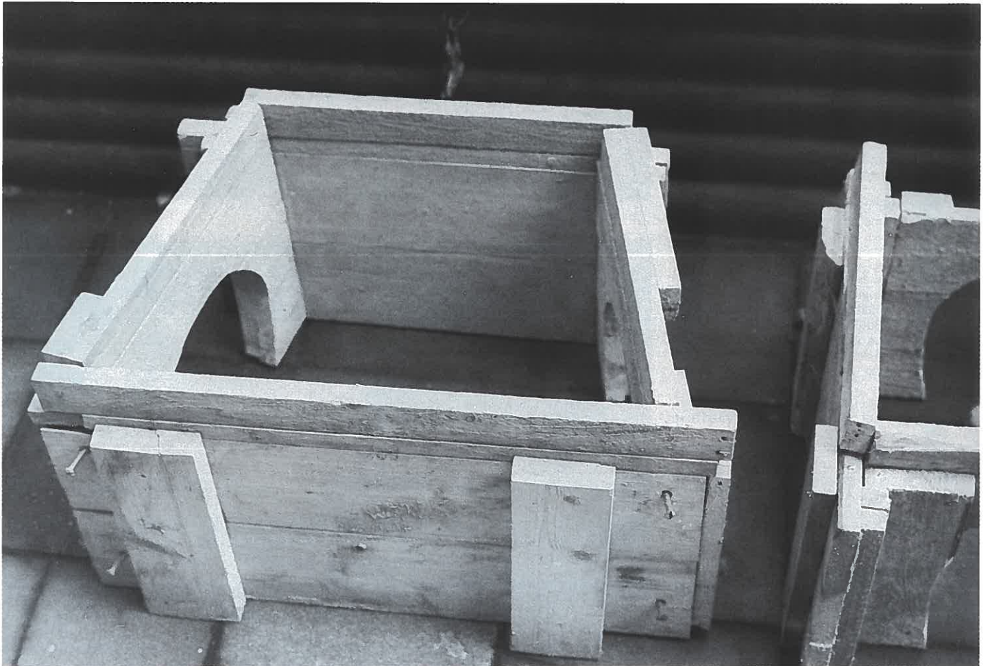
Schalkkasten für Tunnelbausteine (gebogenes Gleis).
