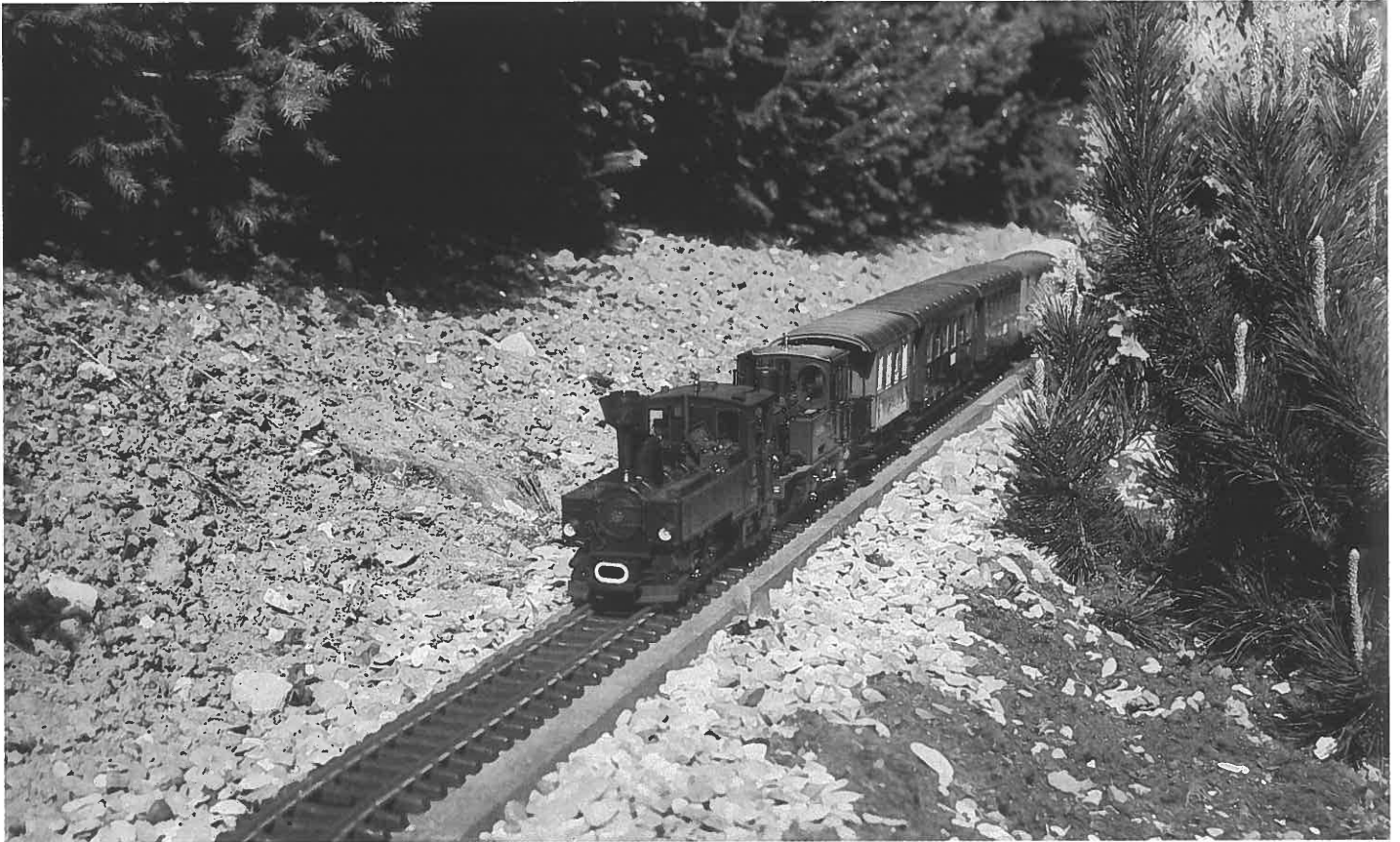
Auch im freien Gelände sind die Gleise auf stabilen Holzbohlen verlegt.
