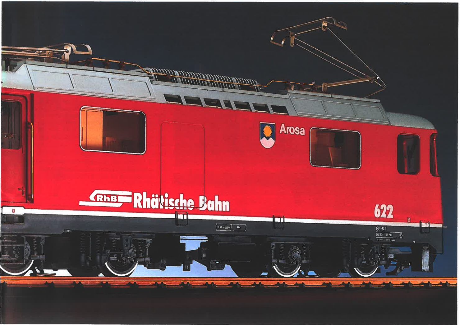
2043: Eine der wenigen, wirklich sensationellen Messeneuheiten war das LGB-Modell der RhB-Elokk Ge 4/4 II. Staunend sahen die Messebesucher, wie sich jeweils der hintere Dachstromabnehmer wechselnd mit der Fahrtrichtung an den Fahrdrabt legte.
