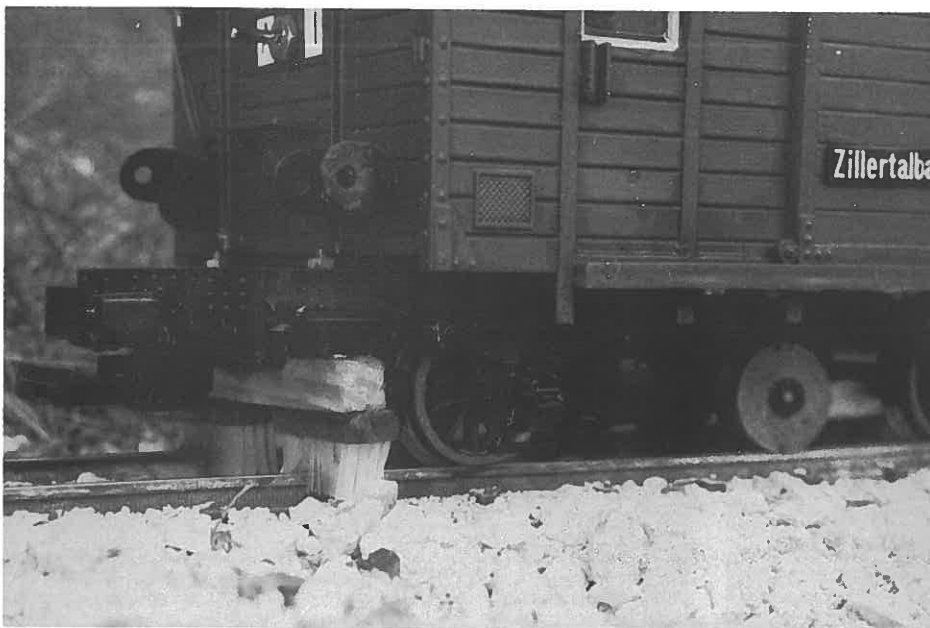
Detailaufnahme vom Werkstattwagen. Deutlich sind zu erkennen die Halterungen des abgenommenen Schneepflugs, der aus Zahnbürsten gebastelte Schienenbesen und die Schleifscheiben des NÜMO-Schienenreinigers.
